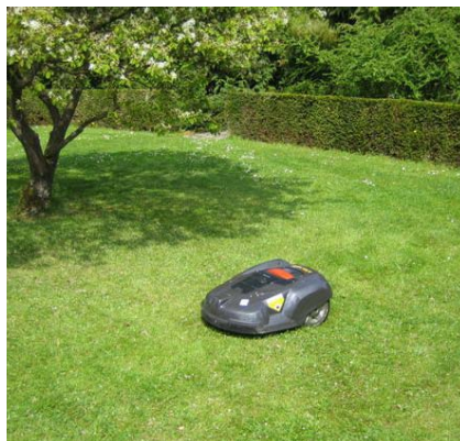
Afprøvning Husqvarna Automower 239ACX på urnefællesgrav, ca. 1200 m 2 , ingen urner nedsat efter 1986, få buketter, 4 store indhak, forhøjet cirkel i midten, spredte træer. Kapacitet 3000 m 2 .
