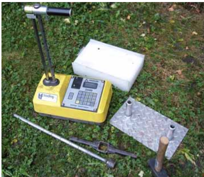
Udstyret til en isotopsondemåler 3440 fra firmaet Troxler indeholder blok til kalibrering, plade med bøsningssør til nedramning af jordspyd forud for instrumentets anvendelse. Foto: Jan Støvring.
