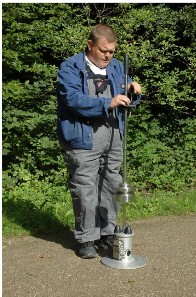
Figur 6. Udførelse af minifalddlods måling på Slotsgrus i Frederiksberg Have (fotograf: Palle Kristoffersen, Skov & Landskab - KVL).
